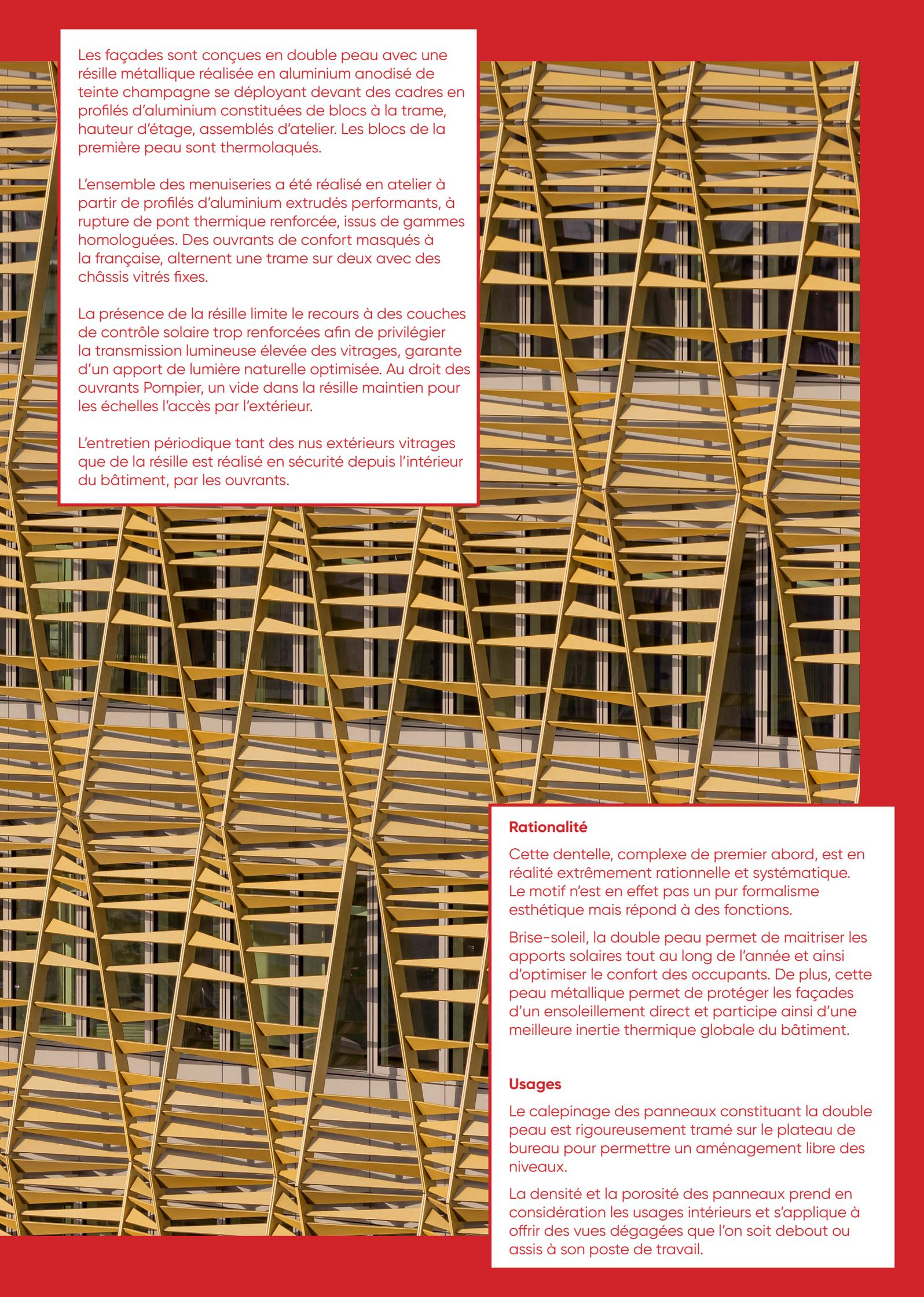
Les façades sont conçues en double peau avec une résille métallique réalisée en aluminium anodisé de teinte champagne se déployant devant des cadres en profilés d'aluminium constituées de blocs à la trame, hauteur d'étage, assemblés d'atelier. Les blocs de la première peau sont thermolaqués.
