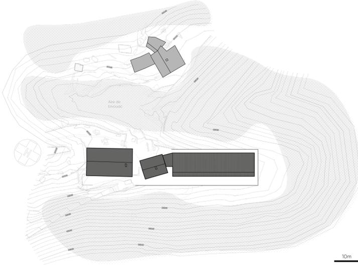
修建这座建筑时，我们的原则是尽可能地忠实于周围的自然环境，并与高山草场和谐共处。最后确定的建筑方案可以将现有隐蔽所的面积扩大两倍。现有隐蔽所包括两个部分，均由大型石块修建而成，美丽又壮观。在遵循现有建筑原理的前提下，于现有建筑物的西侧也就是原有冰碛的延伸带上，新建一个体积更大的建筑物。这三座建筑物是分开的：我们在设计时着重保护看守人和助手的安宁和舒适，同时尽量满足大型团队、登山者和徒步者的需求（希望保留私密性，拥有各自的活动时间和活动空间）。根据我们提出的方案，区分了冬季区和夏季区。隐蔽所位于冰碛地带，必须采取相应措施，避免遭受雪崩影响：主立面朝向正南。隐蔽所自然融入了山区小村庄。如果用这个建筑借鉴了山区传统农庄建筑形体风格，那么使用的新材料必须是现代的。这些材料既要符合当前的施工方法又满足高效隔温的严格标准，以便应对最恶劣的气候。建筑物的蒙皮由末端弯曲折叠的铝薄板制成，其纵向施工缝不规则且随机分布在岩壁上。建筑蓬皮为板岩颜色，很好地呈现出庇护所上方的页岩矿脉的颜色。这种“皮肤”在白天扮演“吸热黑体”的角色，收集最大的热量。
